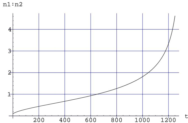
Abbildung 2: Verhältnis der Drehzahlen  $n_1(t) : n_2(t)$  über der Zeit
